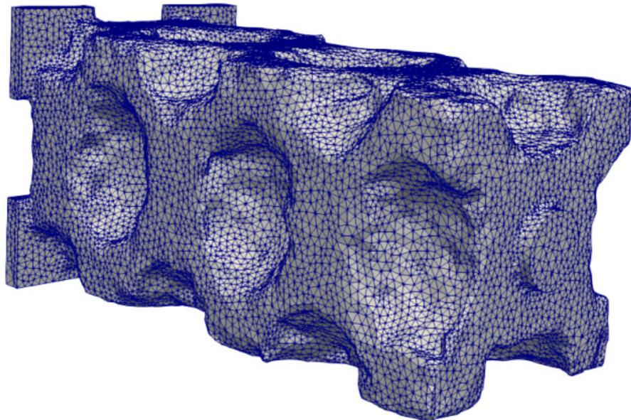
Figure: Optimisation d'une console en flexion
