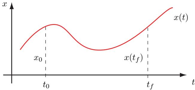
*Grundidee:* Unterteile das Intervall  $[t_0, t_f]$  in Teilintervalle:  $t_0 < t_1 < \dots < t_n = t_f$ , und approximiere sukzessive  $x(t_1), x(t_2), \dots, x(t_n)$ . Damit wird das ursprünglich globale Problem in eine Folge lokaler Probleme zerlegt.
